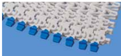
S11 | durchlässige (45 %) Oberfläche | Hold Down Caps
